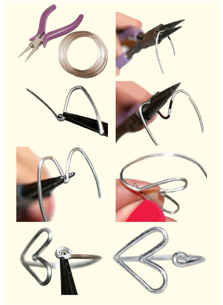
Fig. 1. Operații tehnologice de realizare a unei brățări
