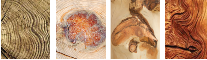
Fibră creață Pungi de rășină Înfundări ale coajei Fibră răsucită Fig. 21 Defectele lemnului
